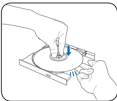
步骤四：欲取出光盘，使用中指按住光驱托盘中央轴承，食指将光盘边缘向上拨动即可取出。
