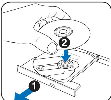
步骤三：一手将光盘轻轻压入托盘定位，另一手请轻扶着托盘。确定光盘置放定位后，再将托盘轻轻推入插槽中。
