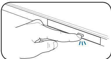
步骤二：请将光驱托盘完全拉出。
